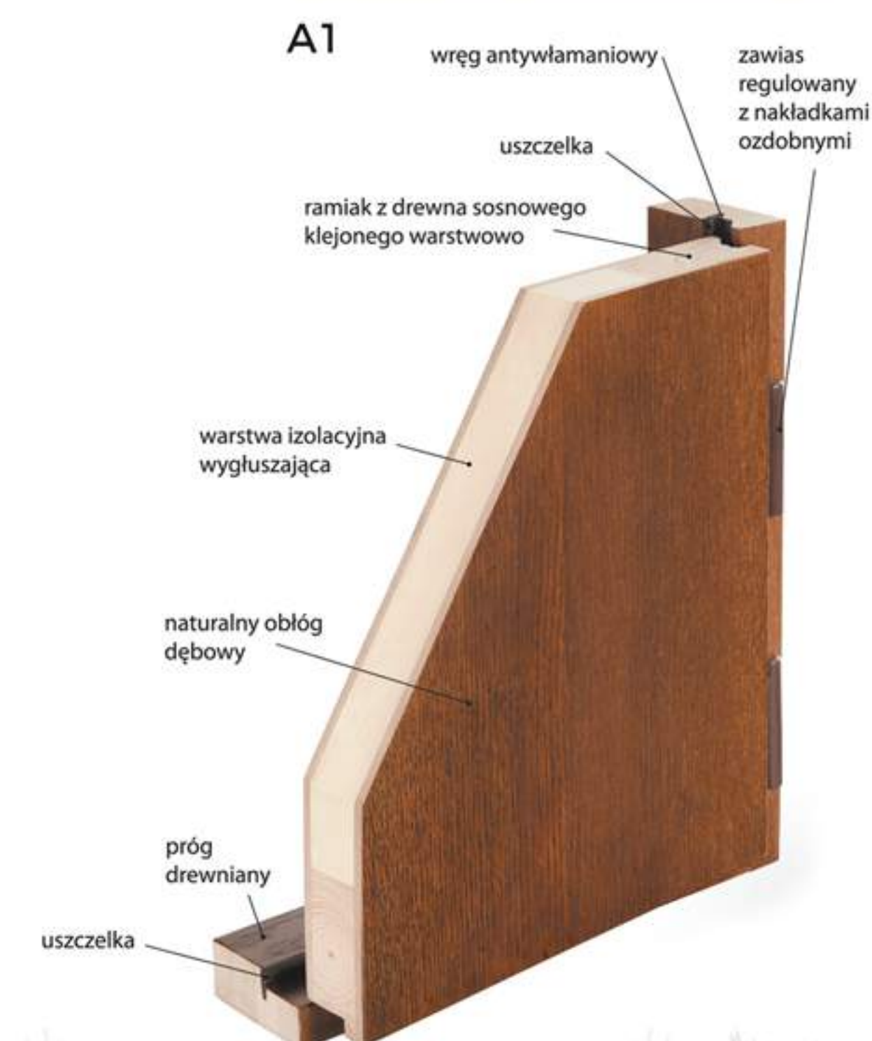
PRZEKRÓJ DRZWI PŁYCIKOWYCH
